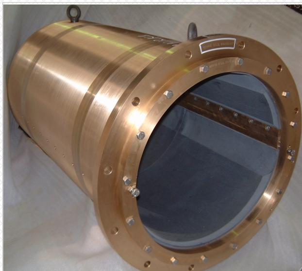
Les matériaux en composite *FEROFORM* et *RAILKO* sont homologués et utilisés par les Forces Navales pour les arbres de propulsion et les axes de gouvernail des sous-marins où les opérations de positionnement sont vitales.
