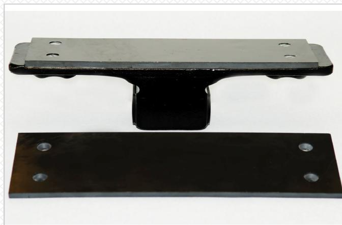
Gli SBL (Side Bearer Liners) di **TENMAT** in RAILKO NF21, approvati da UIC, sono installati sui pattini laterali dei carrelli merci per offrire supporto alle oscillazioni della cassa. I pattini RAILKO sono utilizzati per garantire una manovrabilità del carro in piena sicurezza nelle curve presenti sul percorso.
